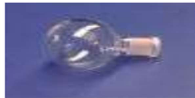
الدورق المستدير Round bottom flask ويستخدم للغليان والتقطير
