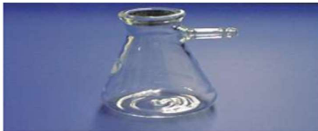
الدورق المخروطي ذو فتحة جانبية يستخدم في الترشيح تحت الضغط المخلخل
