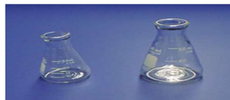
الدورق المخروطي Conical flask و يسمى ايضاً Erlenmeyer flask ويستخدم في الخلط والمعايرة والتسحيح
