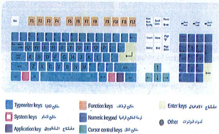
الشكل (2-4) التقسيم النموذجي للوحة المفاتيح
