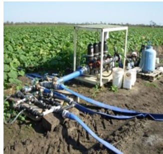
وحدة الضخ في منظومة الري بالتنقيط مع المضخة الانتبازيه الطاردة المركزية
