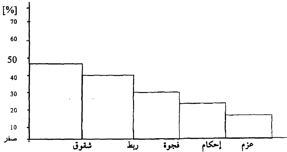
شكل (9.8) مخطط باريتو لعيوب عملية إنتاجية
