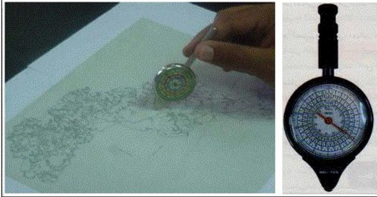
وتتلخص طريقة استخدام هذا الجهاز ، باننا أولاً نقرأ مقياس الرسم للدوائر داخل قرص العجلة ونختار أحداها والذي يتشابه مع مقياس رسم الخارطة ، ثم نثبت المؤشر على الصفر ونبدأ بوضع الترس المسنن على بداية البعد على الخارطة ، وبعد ذلك نبدأ بتحريك العجلة ملاصقة للبعد على الخارطة وبشكل عمودي ، فيأخذ المؤشر في نفس الوقت بالحركة أيضاً . وعند التوقف في نهاية البعد نقرأ الرقم الذي توقف عنده المؤشر ، وبذلك يكون هو البعد الحقيقي على الطبيعة .
