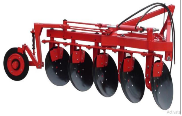
شكل 8: محراث قرصي قلاب ذو أتجاهين (يمين)، محراث مطرحي قلاب ذو أتجاهين (يسار)
