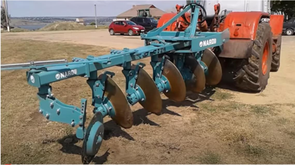
شكل 1: محراث قرصي قلاب ذو اتجاه واحد (أعلى)، محراث قرصي قلاب ذو اتجاهين (Reversible) (أسفل)
