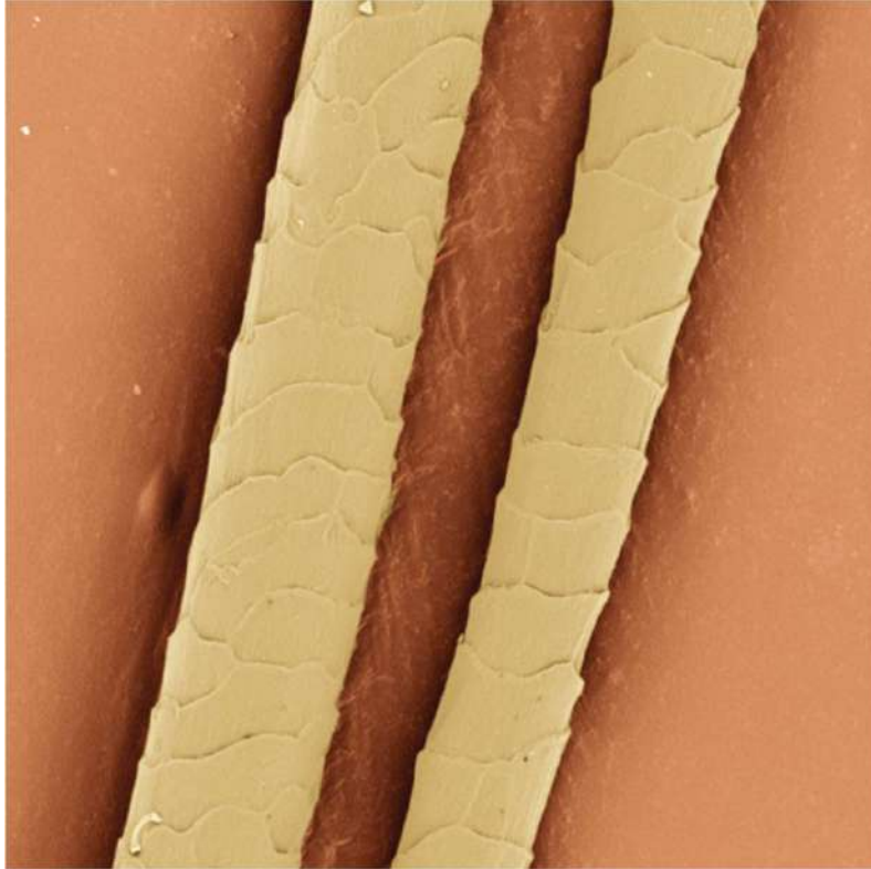
شكل 8: مقطع طولي لألياف مريينو. ألياف ناعمة (يمينا) تصور نمط الحراشف شبه الإكليلي إلى الإكليلي حيث تطوق الحراشف العمود بأكمله. ألياف خشنة (يسار) عرضها أكبر ونمط حراشف مختلف عن الألياف الناعمة (يمين) (1500 ×).
