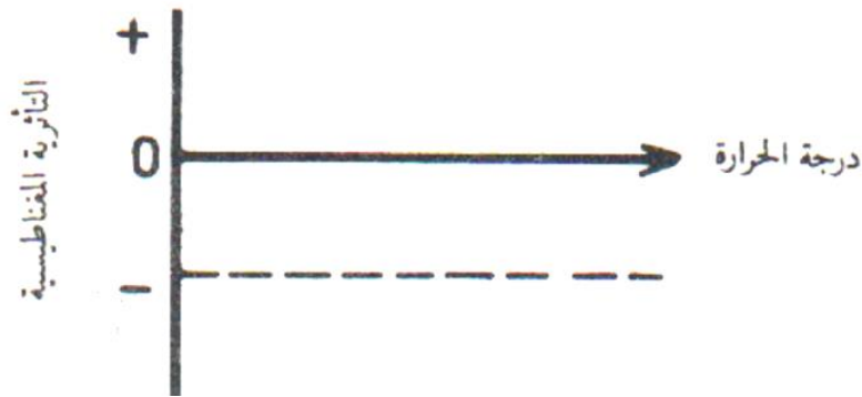
الشكل (1) علاقة التأثيرية المغناطيسية مع درجة الحرارة للمواد الدايامغناطيسية
