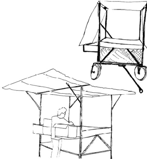
وهناك نموذج اخر للتعبئة في الحقل وهو عبارة عن وحدة ذاتية الحركة تمكن العمال من قطع وتهذيب وربط أو لف وتعبئة المحصول في الحقل مما يوفر استخدام وتشغيل محطة تعبئة مكلفة. وفي الشكل الموضح ادناه نلاحظ تحرك سيارة ذات مسطبة مكشوفة تسير بمحاذاة وحدة التعبئة في الحقل حيث يتم تحميل المحصول المعبأ على هذه السيارة استعدادا لنقله.
