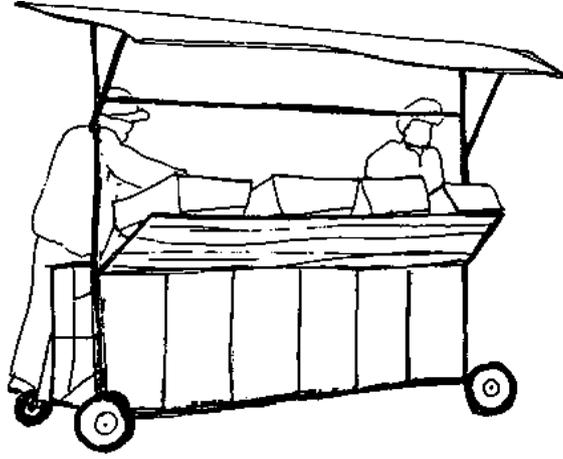
النموذج التالي يوضح عربة اكبر تناسب التعبئة في الحقل وهي مصممة لكي يتم جرها بواسطة جرار الى داخل الحقل عند حصاد المحصول ويستخدم هذا النموذج في التعبئة في الحقل لكثير من المحاصيل. ويمكن تقفيل سقفها الى اسفل لتسهيل عملية نقلها وعند فتح السقف فانه يوفر مساحة ظل كبيرة للقائمين بالتعبئة وتظليل المحصول نفسه. ويمكن تعديل تصميم هذا النموذج بما يتناسب مع المحاصيل المختلفة وحجم العمليات المختلفة.
