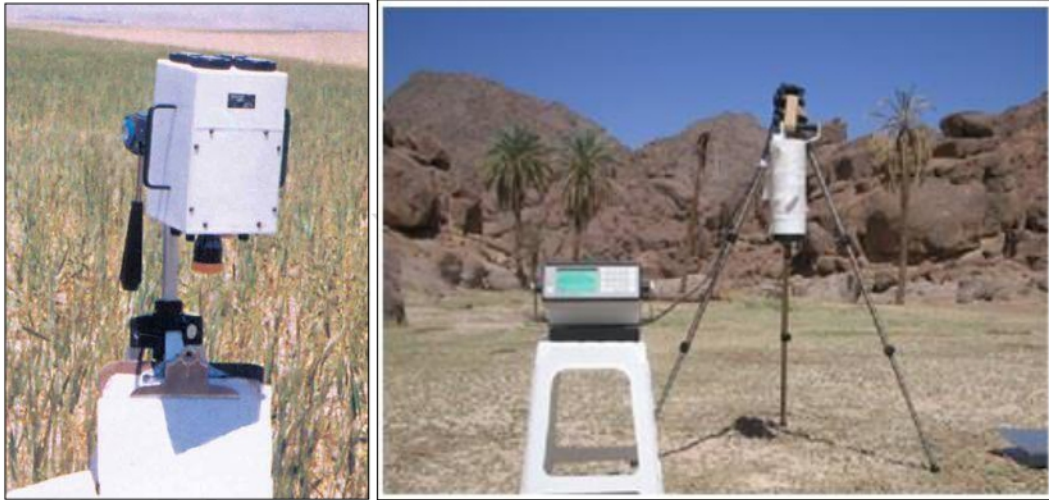
شكل (40) مقياس أشعة الراديو متر مركب على قاعدة أرضية
