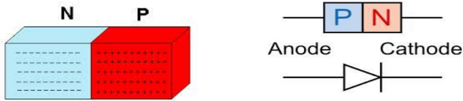
شكل (1-2) تركيب ورمز الوصلة الثنائية PN
