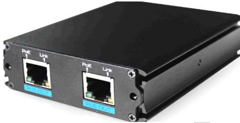
جهاز Repeater لتكرار اشارة البيانات مع الاشارة الكهربائية، يحتوي على منفذين من نوع PoE
