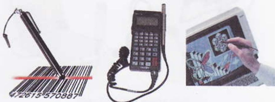
الشكل (2-14) أشكال من القلم الضوئي واستخداماته
