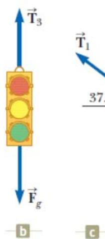
الحل: رسم رسمًا تخطيطيًا للقوى المؤثرة على إشارة المرور، كما هو مبين في الشكل b، ومخطط الجسم-الحر diagram of the forces للعقدة التي تربط الأسلال الثلاثة معاً كما هو موضح بالشكل c. هذه العقدة knot هي الجسم الملائم للاختيار، لأن كل القوى تؤثر على امتداد خطوط تمر عبر هذه العقدة.
