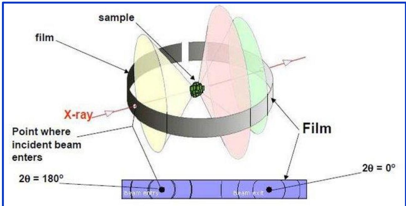
بعد إجراء الحيود لوقت كافي يظهر لوح التصوير بعد تطهيره (تحميضه) نموذج حيود كالمبين في الشكل الآتي . يقابل كل قمة حيود ( كل خط أسود ) على لوح التصوير تداخل بناء عند مستويات لها مسافة بينية  $d_{hkl}$ . الآن، تكمن المشكلة في تعين أدللة ميلر (hkl), لخطوط الحيود.
