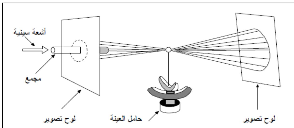
يمكن تسجيل حيود الأشعة بطريقة ملائمة بواسطة كاميرا بولارويد Polaroid camera أو بواسطة أي جهاز تصوير الكتروني. يمكن تحليل نماذج حيود الأشعة المشتتة النافذة أو الأشعة المشتتة المرتدة بالانعكاس من البلورة والتي يتم الحصول عليها على ألواح التصوير، كما هو مبين في الشكل الآتي الجزئين) أ (و) ب (على وجه الترتيب والتوالي.
